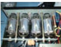
Verbunden sind sie ueber einen Platinenstreifen mit 4 Kaepfchen. An allen Roehren liegt die gleiche Anodenspannung.
